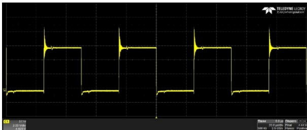
Figura 9. Señales de conmutación de un MOSFET.
