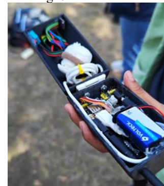
Fig. 6. Interior del satélite, el tripulante se ubica en el centro de la carcasa izquierda
