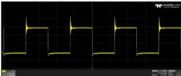
Figura 9. Señales de conmutación de un MOSFET.
