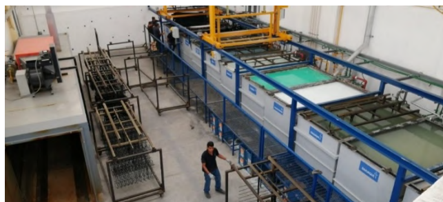
Figura 2. Proceso de pintura electroforética. Cortesía de la empresa Recubrimientos especializados en pintura electrolítica (REPESA)
