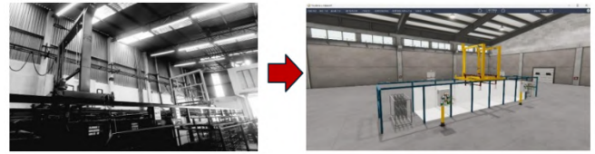
Figura 15. Línea de Producción Real – Línea de Producción Virtual para el gemelo virtual.
