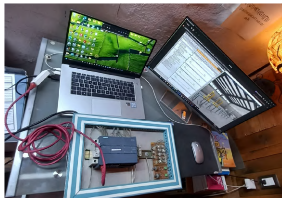
Figura 32. Conexión del PLC físico con la línea de pintura electroforética.
